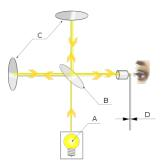
Suponha que as características do experimento são as seguintes: (i) a fonte de luz é monocromática, com um comprimento de onda de  $\lambda=500$  nm = 5.  $10^{-7}$  m; (ii) os braços do interferômetro (distâncias B-C) são de 10 m .
