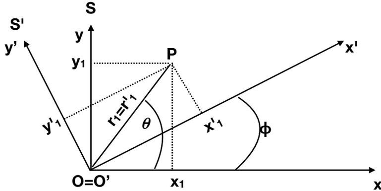
Figura 4: Dois referenciais  $S$  e  $S'$  rodados de um ângulo  $\phi$ .
