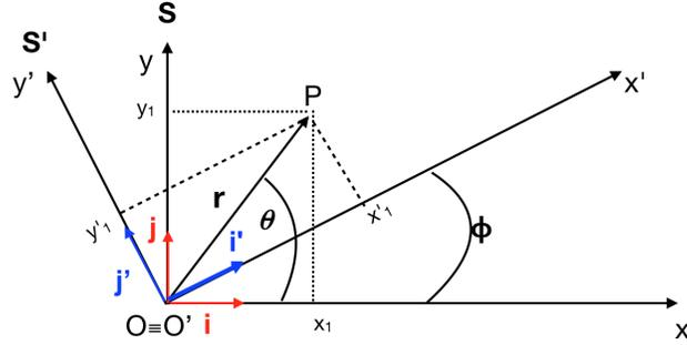
Figura 8: Descrição do vetor deslocamento  $\mathbf{r}$  em  $\mathbf{S}$  e  $\mathbf{S}'$ , dois sistemas de referência rodados um em relação ao outro de um ângulo  $\phi$ .
