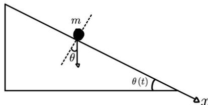
Figura 1: Plano inclinado com ângulo variável.
