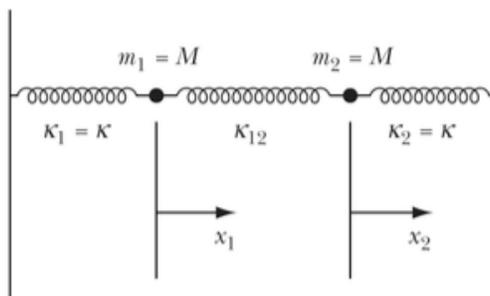
Figura 2: Osciladores acoplados.
